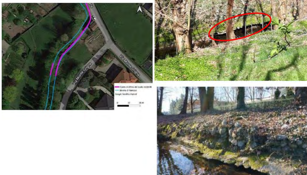
Figura 1-12 Criticità D1: Scalzamento al piede di una gabbionata realizzata a protezione di un collettore fognario
