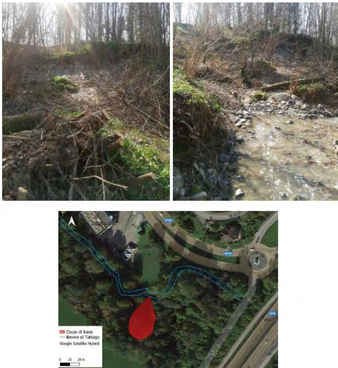
Figura 1-18 Criticità E1: Vista del corpo di frana dall'alveo. Parte del materiale si è depositato lungo la sponda sinistra della Bevera.
