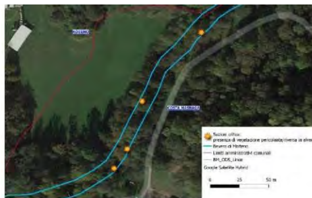
Figura 1-6 Criticità B3: Alcune problematiche riscontrate durante il sopralluogo (tratto fluviale mostrato nel riquadro in basso a destra) legate principalmente alla presenza di piante pericolanti o riverse in alveo.
