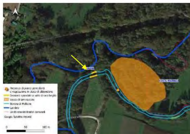
Figura 1-9 Criticità C1: Sponda destra del torrente a valle dell'opera trasversale interessata dalla presenza di piante e significativamente erosa.
