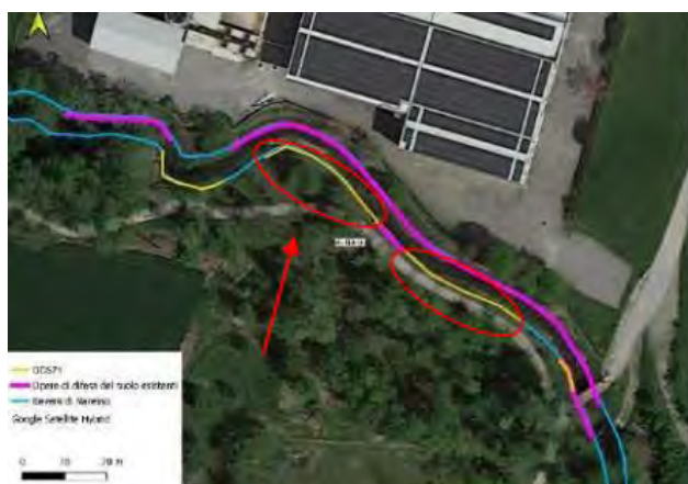
Figura 1-14 Criticità D2: Marcata erosione spondale in sinistra idrografica a monte e a valle di un tratto protetto da scogliera
