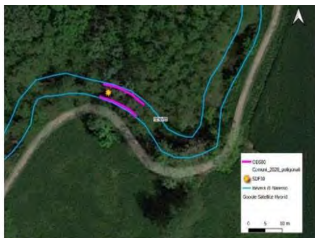
Figura 1-16 Criticità D3: Presenza significativa di vegetazione riversa in alveo e di una scogliera in parte collassata in alveo
