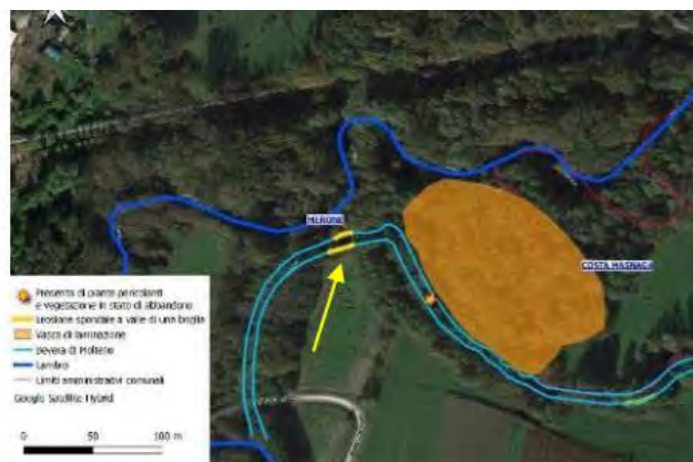
Figura 1-8 Criticità C1: Sponda sinistra della Bevera e opera trasversale soggetta a marcata erosione. In giallo è evidenziata l'instabilità alla base della briaglia.
